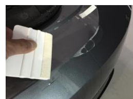
フィルム貼り、付属のヘラで水・気泡を抜きながら貼り付けます。
