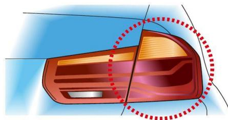
車両外側のウィンカーが遅れて点灯します。
