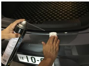
リアバンパー(施工部分)を綺麗に洗浄(脱脂処理)します。
