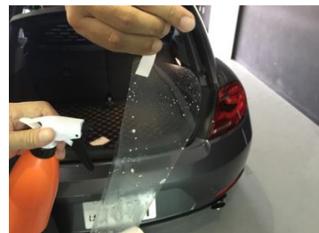
リアバンパー及びフィルム(貼付け面)に霧吹き(別途用意)で水を吹きます。
