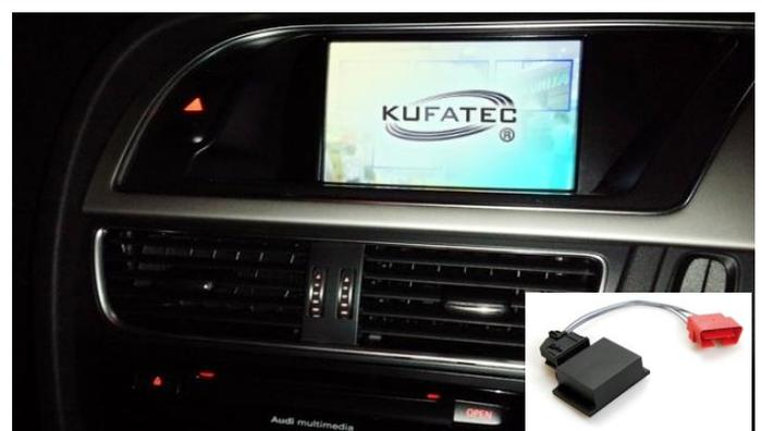
アイドリングストップ機能が搭載された車両にインストールすることで、アイドリングストップをキャンセル出来ます。車両の診断ポート(OBD IIポート)に接続するだけの簡単インストール。
