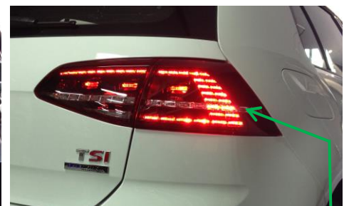
[ Golf7 R LEDテールレンズ装着 ] 取付専用ハーネスを2set使用。 ※アウター側のポジションにも配線
