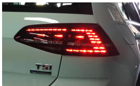
[ Golf7 R LEDテールレンズ装着 ] 取付専用ハーネスを1set使用。 ※インナー側LEDウインカーに配線
