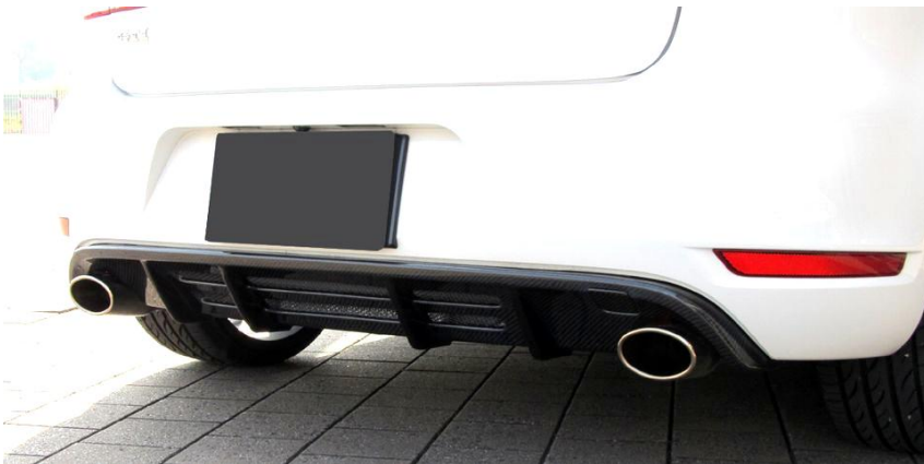
Golf6 GTI純正リアディフューザーと交換タイプの「DTMリアディフューザー」。
